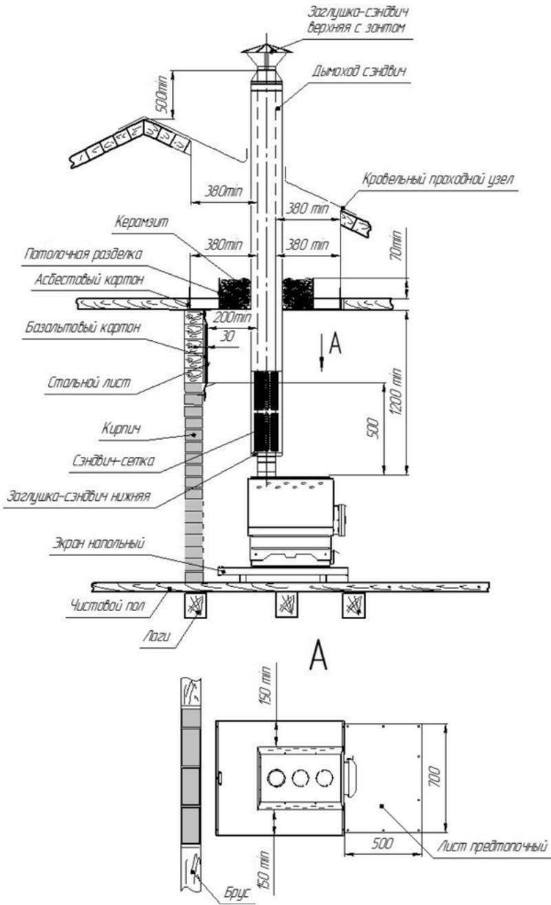
**Рис. 2** Рекомендуемая схема установки печи (дымоход внутри помещения)
